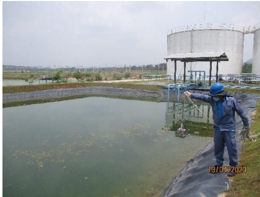
รูปที่ 3.4-9 การเก็บตัวอย่างตะกอนจากระบบผลิตน้ำประปา
